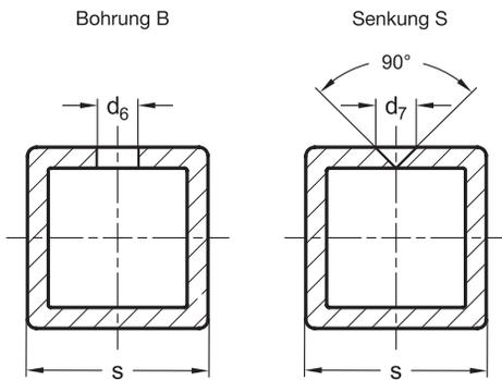
Die Vierkante der Rastschlitten sind auf Konstruktionsrohr GN 990 abgestimmt. Diese können vom Anwender gemäß den in der Tabelle angegebenen Maßen mit Rastbohrungen (B oder S) versehen werden.
