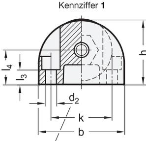
Bohrung für Zylinderschraube ISO 4762
