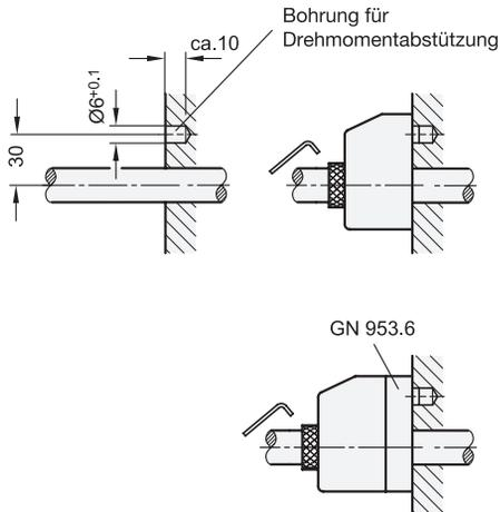
Vor der Montage des Stellungsanzeigers ist für die Drehmomentabstützung maschinenseitig eine Aufnahmebohrung nach nebenstehender Zeichnung anzubringen.
