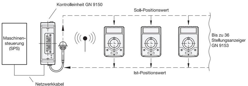
Stimmen Soll- und Ist-Positionswert nicht überein, fängt das LCD-Display des Stellungsanzeigers an zu blinken. Der Maschineneinrichter muss dann den Stellungsanzeiger auf den richtigen Wert einstellen. Das LCD-Display zeigt an, um welchen Wert der Ist-Positionswert vom Soll-Positionswert abweicht und in welche Richtung gedreht werden muss. Es muss solange gedreht werden, bis auf dem Display der Wert 0 erscheint, d. h. Nullabweichung zwischen Ist- und Soll-Positionswert.
