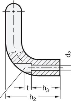
Bohrung für Zylinderschraube ISO 4762
