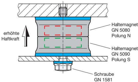
Werden zwei Haltemagnete mit entgegengesetzter Polung kombiniert, wird eine erhöhte Haftkraft erzielt.
