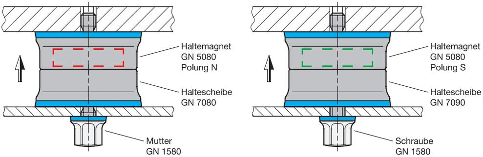
Durch die Kombination von Haltemagneten mit Haltescheiben wird eine normale Haftkraft erzielt. Dabei können Haltemagnete mit Nord- oder Südpol an der Haftfläche gleichwertig verwendet werden.
