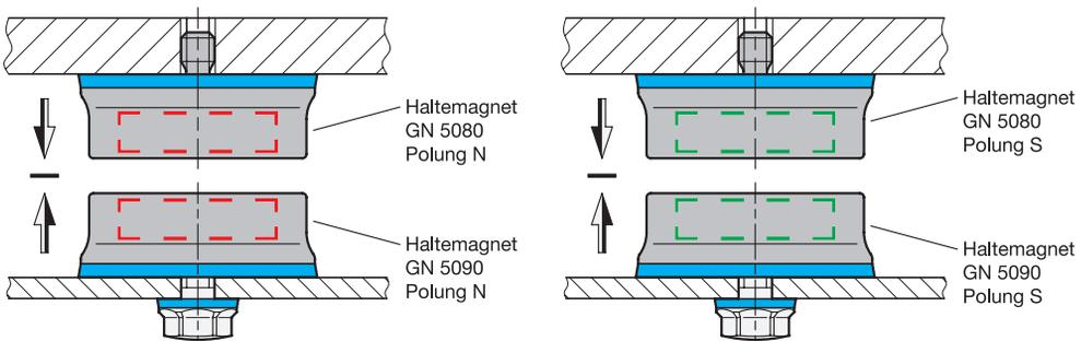
Werden zwei Haltemagnete mit gleicher Polung kombiniert, wird eine abstoßende Kraftwirkung erzielt.
