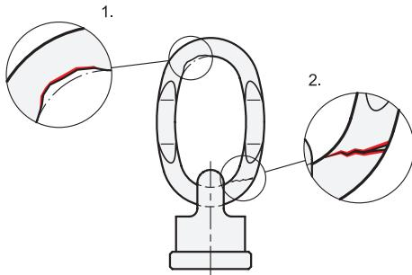
1. Wenn an der Öse eine Abnutzung von mehr als 10 % des Querschnitts vorliegt, ist das Lebensdauerende des Anschlagpunkts erreicht, was auch als Ablegereife bezeichnet wird.
