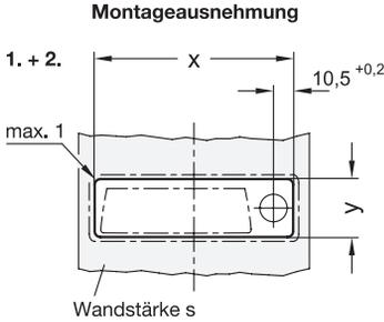
1. Zur Montage wird die Tür bzw. Klappe oder Luke mit einer Ausnehmung gemäß Skizze versehen.
