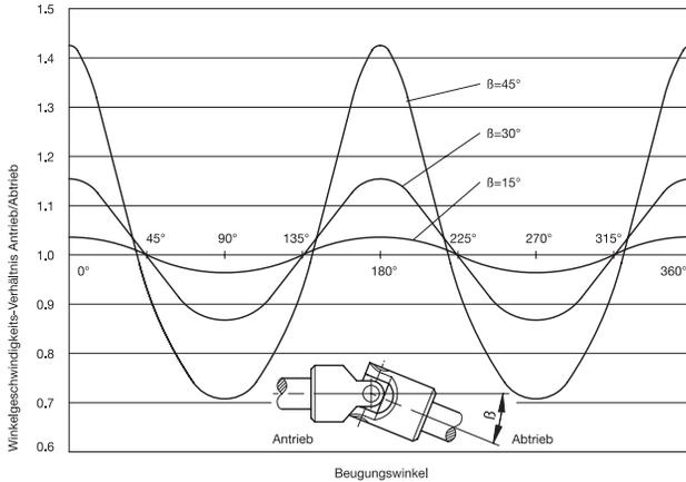
Die Einfach-Gelenke übertragen die eingeleitete gleichförmige Bewegung ungleichförmig, da bei einer Umdrehung der treibenden Welle die angetriebene Welle zweimal beschleunigt und zweimal verzögert wird. Die Größe der Ungleichförmigkeit ist abhängig vom Arbeitswinkel  $\beta$ .
