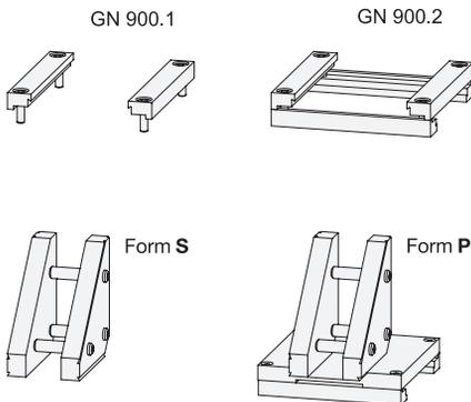
Der Außenschlitten aus stranggepresstem, eloxiertem Aluminium ist in der Regel das Element, welches bewegt wird.
