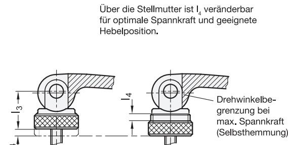
Über die Stellschraube ist  $l_4$  veränderbar für optimale Spannkraft und geeignete Hebelposition.
