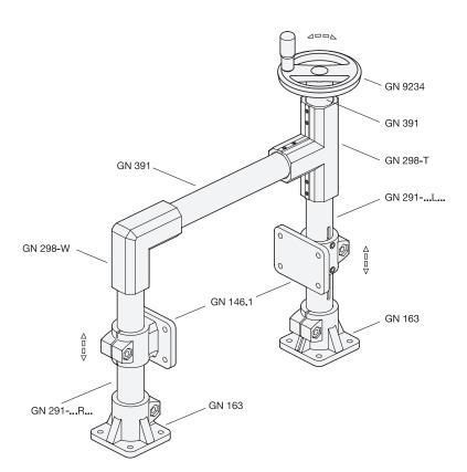
Zwei Verfahrschlitten GN 146.1 werden parallel bewegt. Hierzu sind zwei Lineareinheiten GN 291 über eine Übertragungseinheit GN 391 miteinander verbunden.
