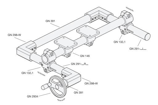
Zwei parallel verfahrende Lineareinheiten GN 291 sind durch eine Übertragungseinheit GN 391 miteinander verbunden. Über die Winkelgehäuse GN 298-W mit eingebauten Kegelradsätzen GN 297 und einer weiteren Übertragungseinheit GN 391 ist das Handrad mit dem System verbunden, rechtwinklig zu den Bewegungsachsen angeordnet.
