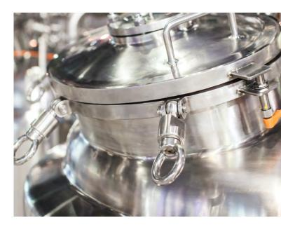
Aus diesem Grund ist gebürsteter, rostfreier Edelstahl der Standardwerkstoff für alle Komponenten in diesem Bereich. Er bietet eine ganze Reihe von Vorteilen:
