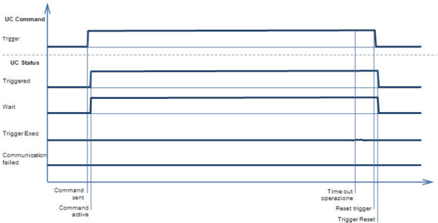
Abb. 10-5 – Zeitablauf der Flags bei nicht erreichbarem Gerät
